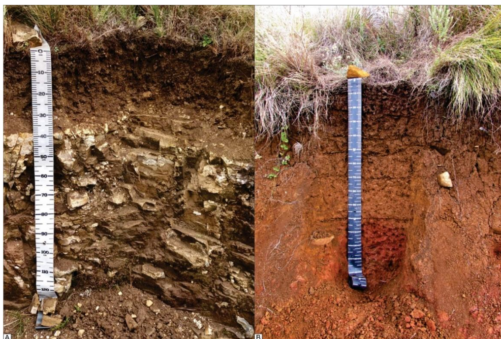
Figura 50. Comparação entre grau de desenvolvimento entre solos formados pelo intemperismo das rochas vulcânicas da: (A) Formação Palmas (menor intemperismo = menor desenvolvimento) e (B) Formação Vale do Sol (maior intemperismo = maior desenvolvimento).
